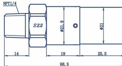
经济型，尺寸紧凑，10/20/50bar，适用于水、空气、大多数冷媒介质
