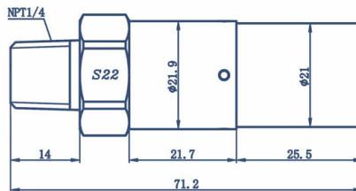
通用型，接液材质316L，全焊接结构，2/5/10/20/50bar，兼容所有介质，适用范围广
